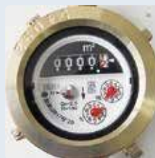
水道メーター
