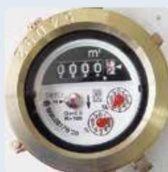
水道メーター
